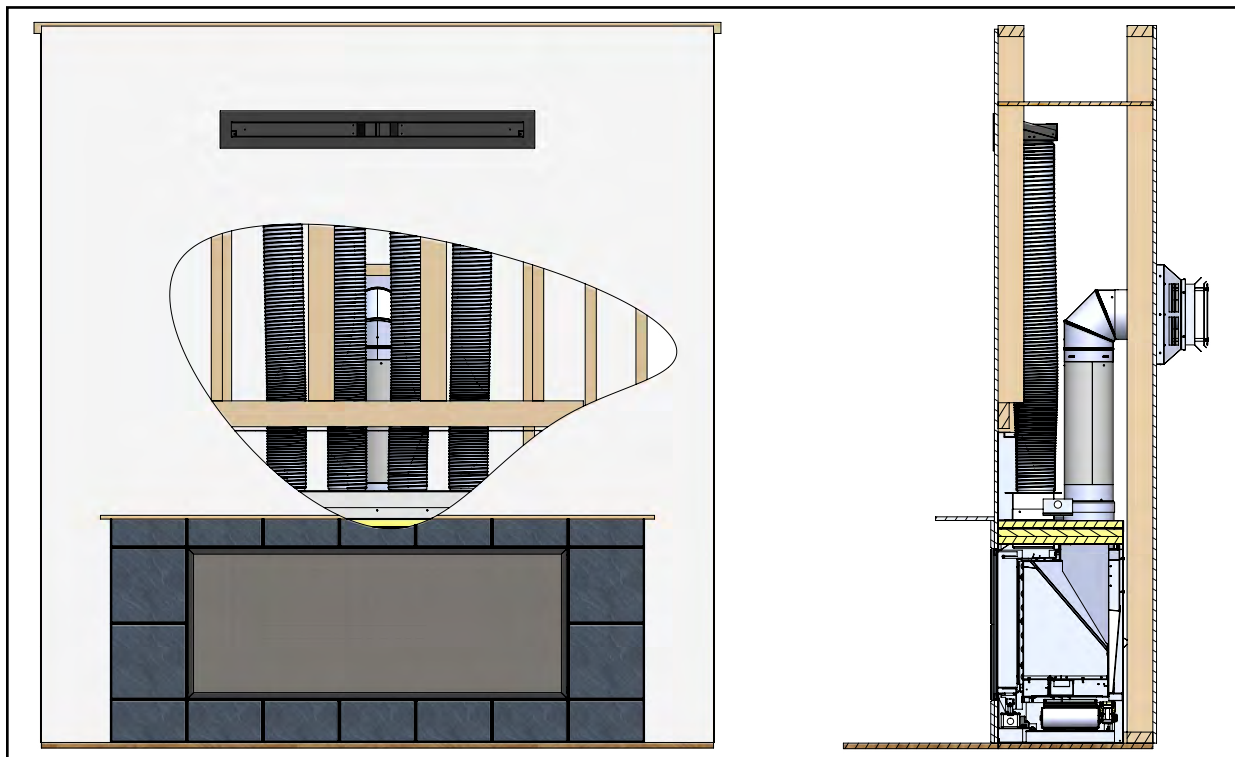
Figure 7.2.01: I.H.E.A.T. - Vue en coupe avec gaine (999-IHT-540)
