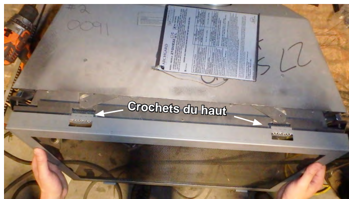
Figure 13.4.02: Insérez les crochets au bas du pare-étincelles entre le cadre de la vitre et la vitre. Insérez simultanément les crochets au haut du pare-étincelles dans les trous au-dessus du cadre de la vitre.
