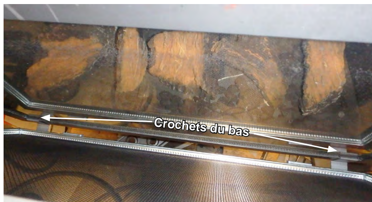
Figure 13.4.02: Insérez les crochets au bas du pare-étincelles entre le cadre de la vitre et la vitre. Insérez simultanément les crochets au haut du pare-étincelles dans les trous au-dessus du cadre de la vitre.
